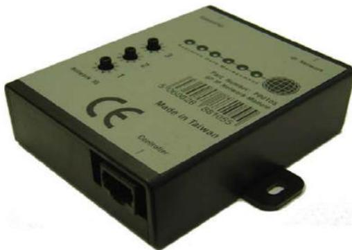
Die IP/ML Futura Schnittstelle verbindet die Mercury/ML Regler mit RS232 mit dem Ethernet (TCP/IP 10BaseT). Die Drehschalter sind zur Eingabe der Adresse zur Erkennung durch z.B. den Datenmanager. Jede andere Adressierung als 000 erlaubt dem DM als DHCP Server den Regler automatisch zu erkennen und zu adressieren. Bei Adresse 000 ist die Adresse in den Regler einzuprogrammieren, damit kann der Regler eine statische TCP/IP Adresse erhalten.
