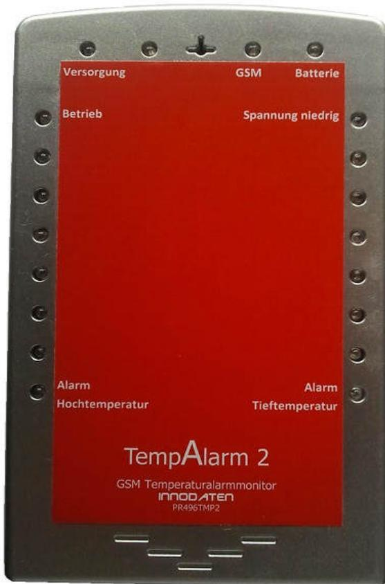
Alarmmodem (GSM) mit Temperaturfühler
