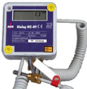
Elektronischer Wärmemengezähler für nasse Fühler mit Impulsausgang (open collector) inkl Eichgebühr und Einbausatz 3/4"x1". 4-Bit Mikrocontroller mit 7-stelligem Multifunktions LCD. Selbstkalibrierender Temperaturmesskreis mit einer Batterielebensdauer von 5 Jahren (+1 Jahr Gangreserve).
