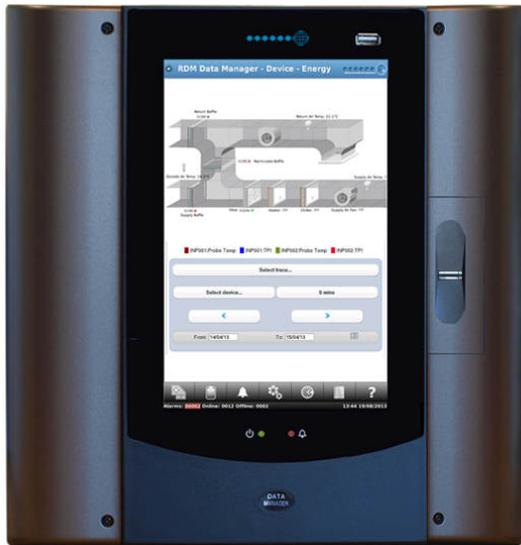
Der DM Touch dient zur Anlagenüberwachung von Gewerken wie Kältetechnik, Klimatechnik, Lüftung, Heizung, Sanitär und Elektrotechnik überwachen, aufzeichnen und regeln wird. Er dient zur Kostenüberwachung, Qualitätssicherung und Funktionssicherheit von technischen Gebäudeeinrichtungen (TGA) und deren zu regelnden Objekten (Heizungsanlage, Kühlmöbel, Energieverbrauch, Beleuchtung, etc...).
