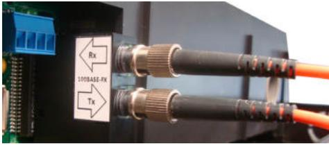
Schnittstelle zur Verbindung der Komponenten via Glasfaserleitung mit langen Leitungslängen > 2000 m für einfach Installation bei Kabelgewichten von ca. 8Kg/1000m.
