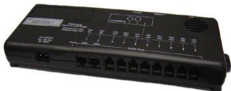
Der Mercury Hub erlaubt es 10 Regler mit RS232 mit einem IP Netzwerk zu verbinden ohne das IP Futura zu benutzen. Der Hub kann netzwerkversorgt (2 Regler) sein, oder über eine eigene Stromversorgung verfügen. Neben den 10 RS232 Buchsen befindet sich eine Ethernet (10baseT) für andere Hubs sowie eine Ethernet uplink Buchse.
