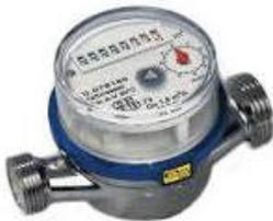
Der Einstrahl - Wasserzähler (Wasseruhr mit Reed-Disc) ist für Kaltwasser bis 30° gebaut und liefert über einen Impulsausgang 1 Impuls je Liter.
