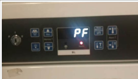
USV des KS nach gezogenem Stecker: PF = Power Fail / Stromausfall + alle 4 Sekunden ein Akustik Signal!
